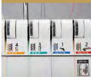
押えを上げ、溝にそってまっすぐに糸を通すだけで、糸調子皿に糸がかかります。太い糸でも簡単に通ります。
