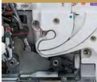
面倒だった天秤への糸掛けがなくなり、溝に沿って通すだけで簡単に糸が掛けられます。
